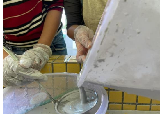
過濾石粉污泥
